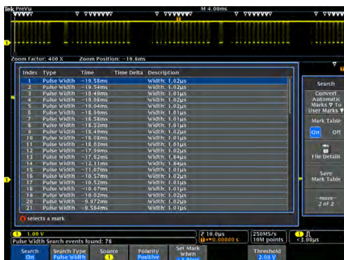
搜索步骤 3：搜索标记 (Search Mark) 表以表格视图呈现了通过自动搜索所发现的每个事件。每个事件都显示有一个时间戳，在事件之间方便地进行定时测量。
