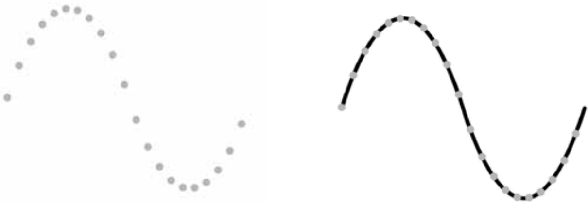
图 17. (左) 表示正弦波的一串样点; (右) 重建的正弦波。
