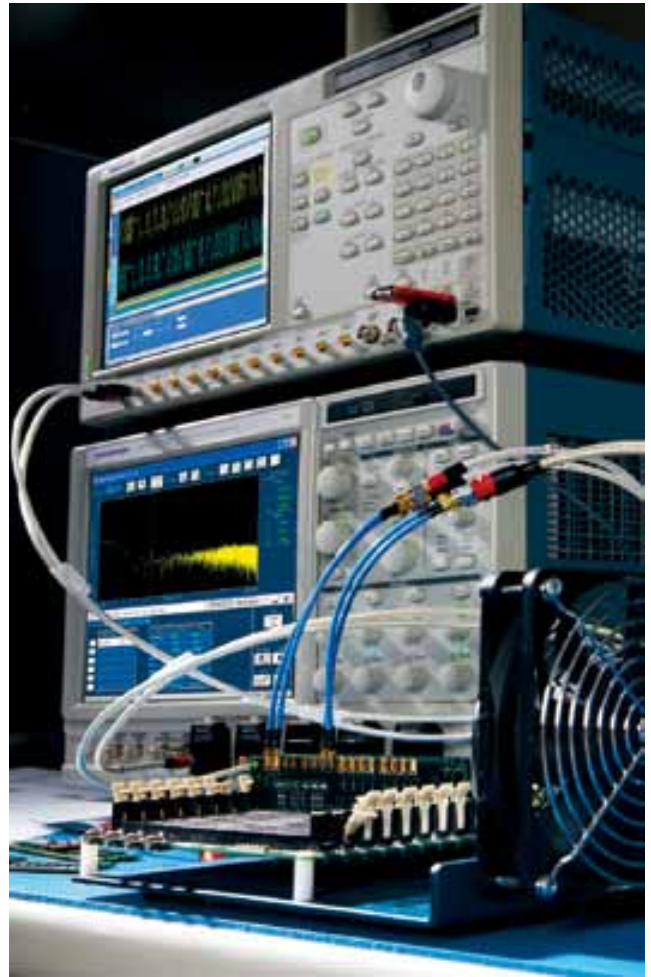
图 1. 大多数测量要求使用由信号发生器及采集仪器配套组成的解决方案。触发连接简化了 DUT 输出信号的捕获工作。
