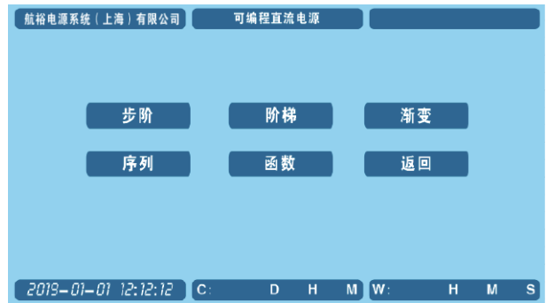
点按所需功能按键，进入对应设置页面 其中序列、函数为选配
