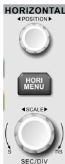
图 1-7 面板上的水平控制区
