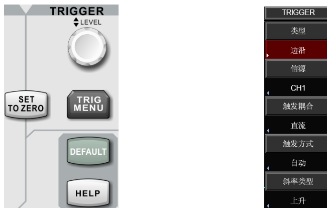
图 1-8 面板上的触发控制区和触发菜单
