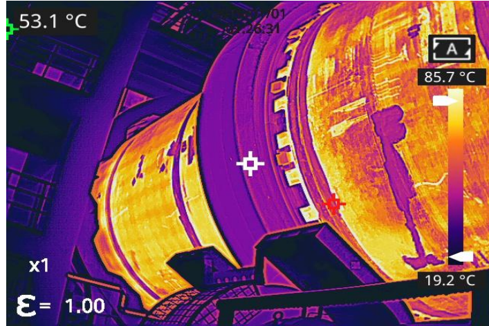
回转窑耐材缺陷监测
