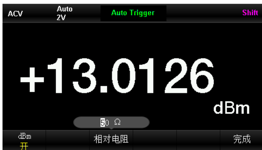
图 3-5 dBm测量界面
