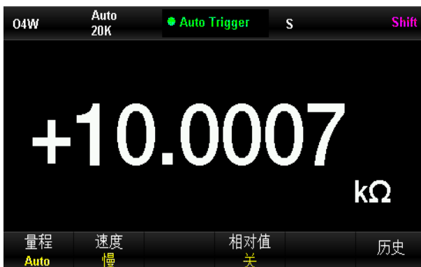
图 2-15 四线电阻测量界面
