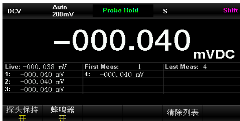
图 2-53 Hold测量界面图
