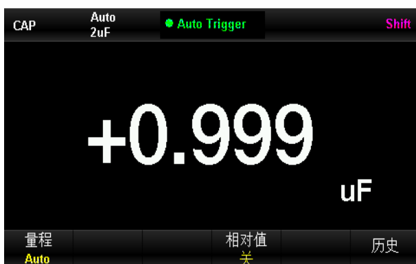
图 2-17 电容测量界面
