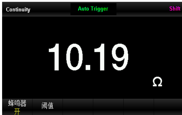
图 2-23 连通测量界面
