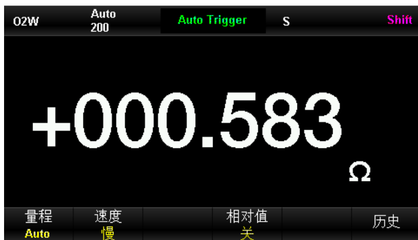
图 3-3 测试线短路读数
