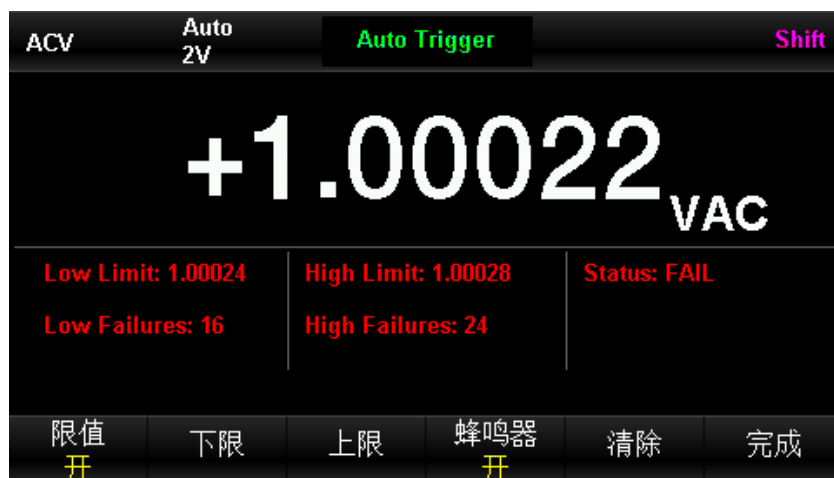
图 3-9 ACV 限值测量界面
