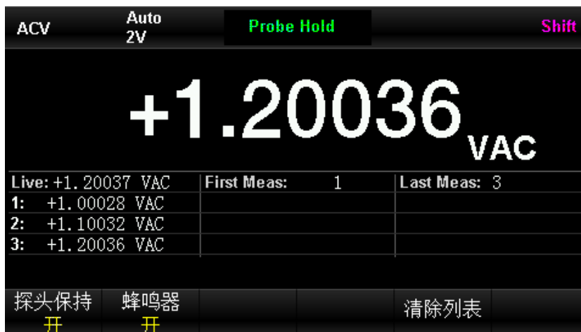
图 3-11 ACV Hold测量界面
