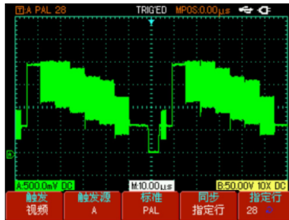
图2-17视频触发：行同步
