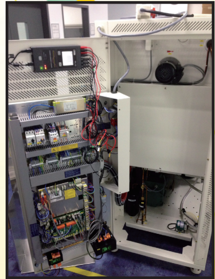
PEL103 磁铁安装在配电板中
