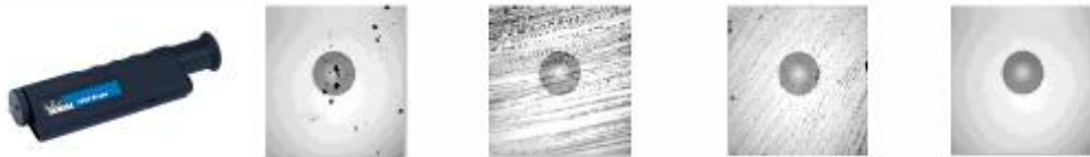
有污垢的连接器 用衣袖和手指“清洁”后的连接器 合格的连接器 45—332 光纤显微镜下观察到的连接器图像
